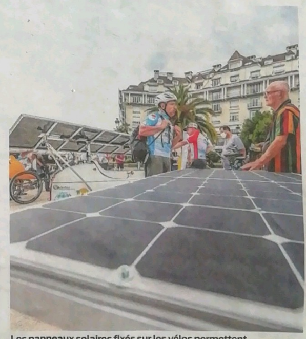
Les panneaux solaires fixés sur les vélos permettent de les alimenter en énergie durant toute la course
